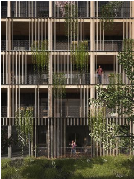
RIBBOR Loftgången kläs i ribbor av trä. Detta gör att fasaden upplevs som öppen och inbjudande från en riktning samtidigt som den upplevs som mer avskilt och privat från den andra riktningen. Referens: Fluvial eco-district of Ile-Saint-Denis, Athletes' Village
