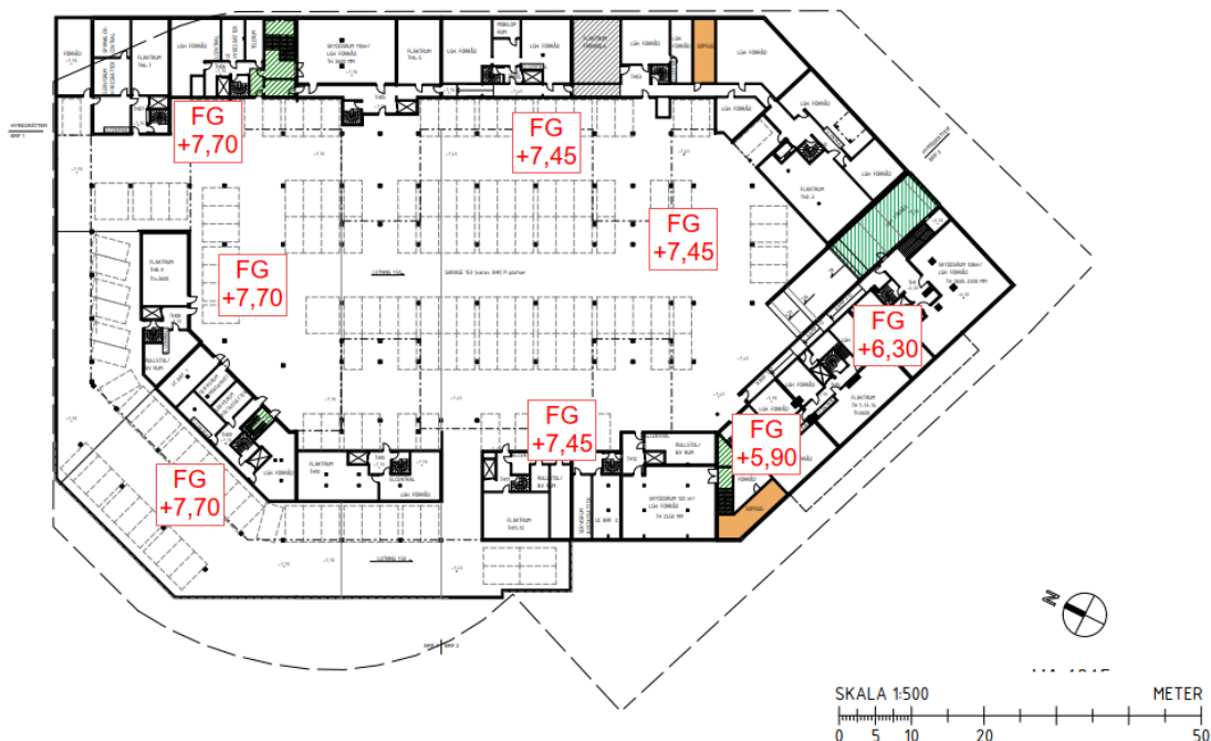
Figur 9 Planritning över garaget till nybyggnad vid Silverskopian 3 (Aleksander Wolodarski Arkitektkontor, 2024). Nivåer i RH 2000 för färdigt golv markeras i rött.
