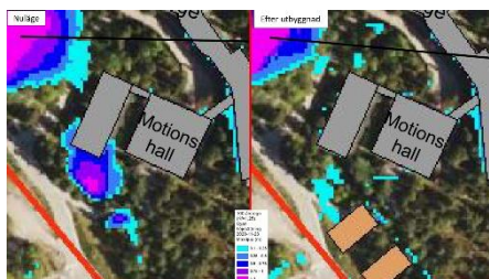
Figur 9. Lågpunkten sydöst om motionshallen som byggs bort efter utbyggnad. Risken för att den befintliga byggnaden tar skada vid skyfall minskar jämfört med idag.
