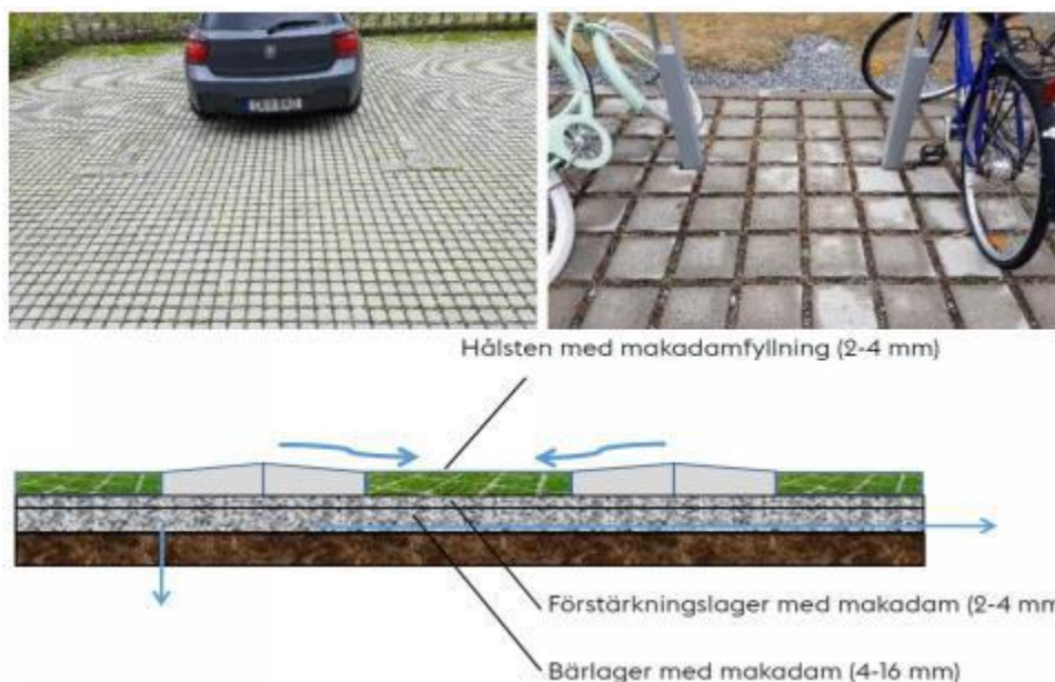
Figur 16. Beläggningsen fungerar som underlag för såväl bil- som cykelparkering. Längst ner i bild visas en principskiss över anläggningens rekommenderade uppbyggnad (Illustration: WRS).
