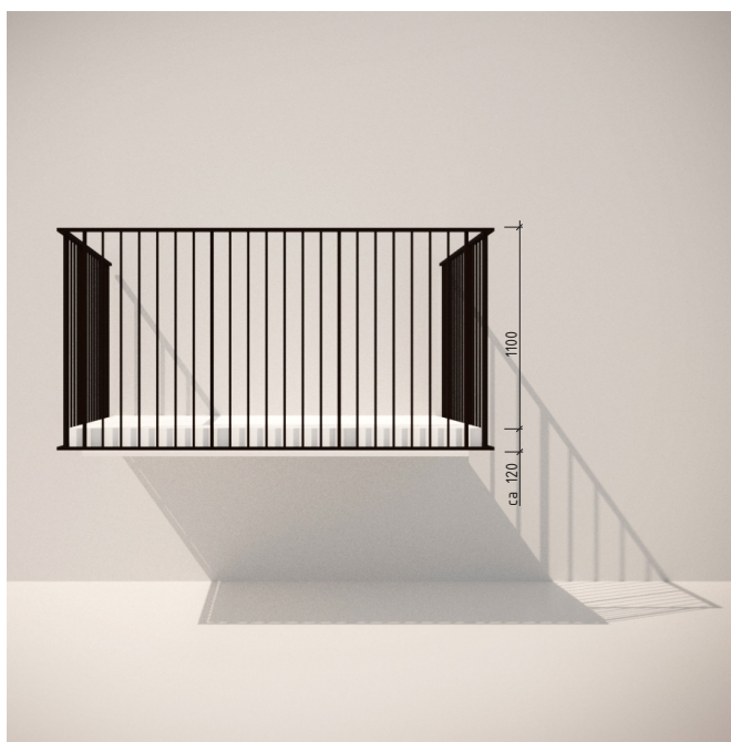
PINNRÄCKE, "DOLD" INFÄSTNING
