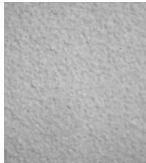
Puttsstruktur 9 Oorganisk ytputs, stänkputs fin, kornmax 2 mm.
