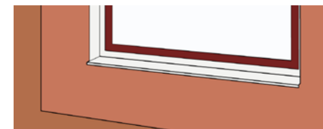
Kulören i en ursparning, i en fasning eller på en omfattning av puts ska gå ton-i-ton med fasaden i övrigt.
