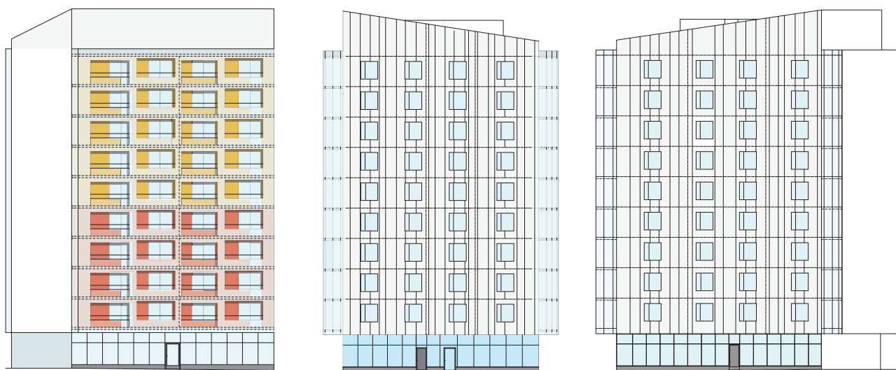
Fasader punkthus mot torg, mot Skogängsvägen resp. mot Å-rummet, Skala 1:500 Element av ljus betong med vertikalt mönster. Tydlig relief med slipade ytor.
