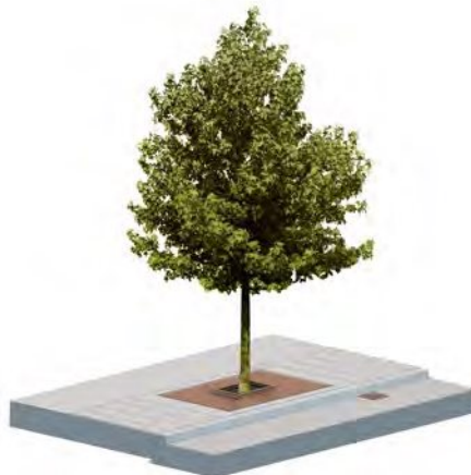
Exempel på dagvattenhantering i gatuträdens växtbäddar, träd i markgaller (huvudgator) respektive träd i planteringsyta (lokalgator).
