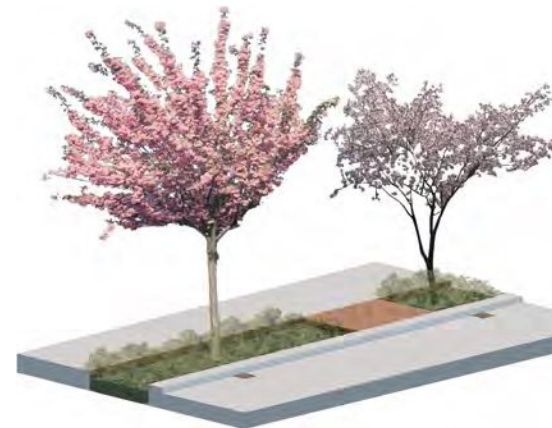
Exempel på dagvattenhantering i gatuträdens växtbäddar, träd i markgaller (huvudgator) respektive träd i planteringsyta (lokalgator).
