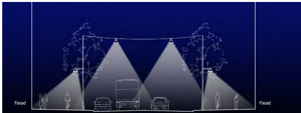
Principsektion belysning huvudgata. Illustration: ÅF/Sweco. Ur Belysningsprogram Årstafältet.
