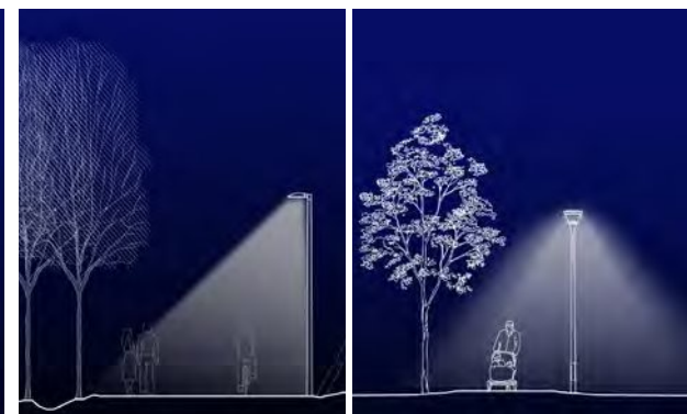
Principsektioner belysning gångvägar. Till vänster stolpe med avskärmad armatur (sektion tagen vid cykelpendlingsstråket längs med Huddingevägen i öster). Till höger stolpe med optisk ledning (armatur som lyser upp sin egen kupa och som ger ströljus åt sidorna). Illustration: ÅF/Sweco. Ur Belysningsprogram Årstafältet.
