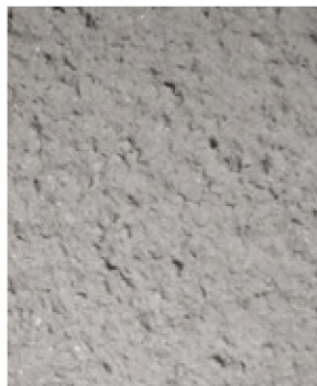
Puttsstruktur 8. Oorganisk ytputs, rivputs grov, kornmax 3 mm
