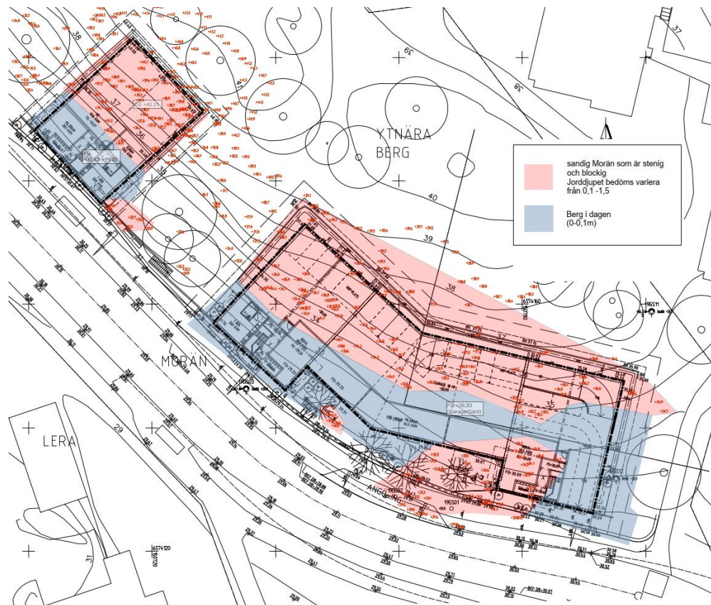
Figur 8. Tolkade markförhållanden baserat på inventerade undersökningar och karteringar. Röda nivåer är inmätt berg i dagen.
