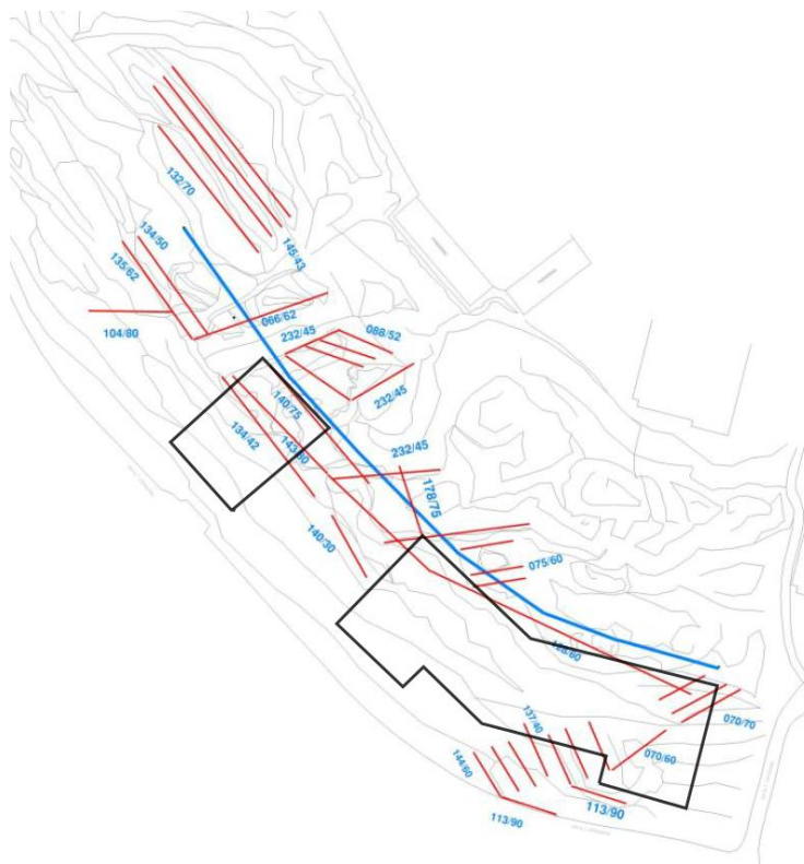
Figur 10. Skiss med redovisade sprickriktningar (Geosigma 2020). I figuren har den nu gällande strukturplanen, daterad 2024-06-20 lagts in.
