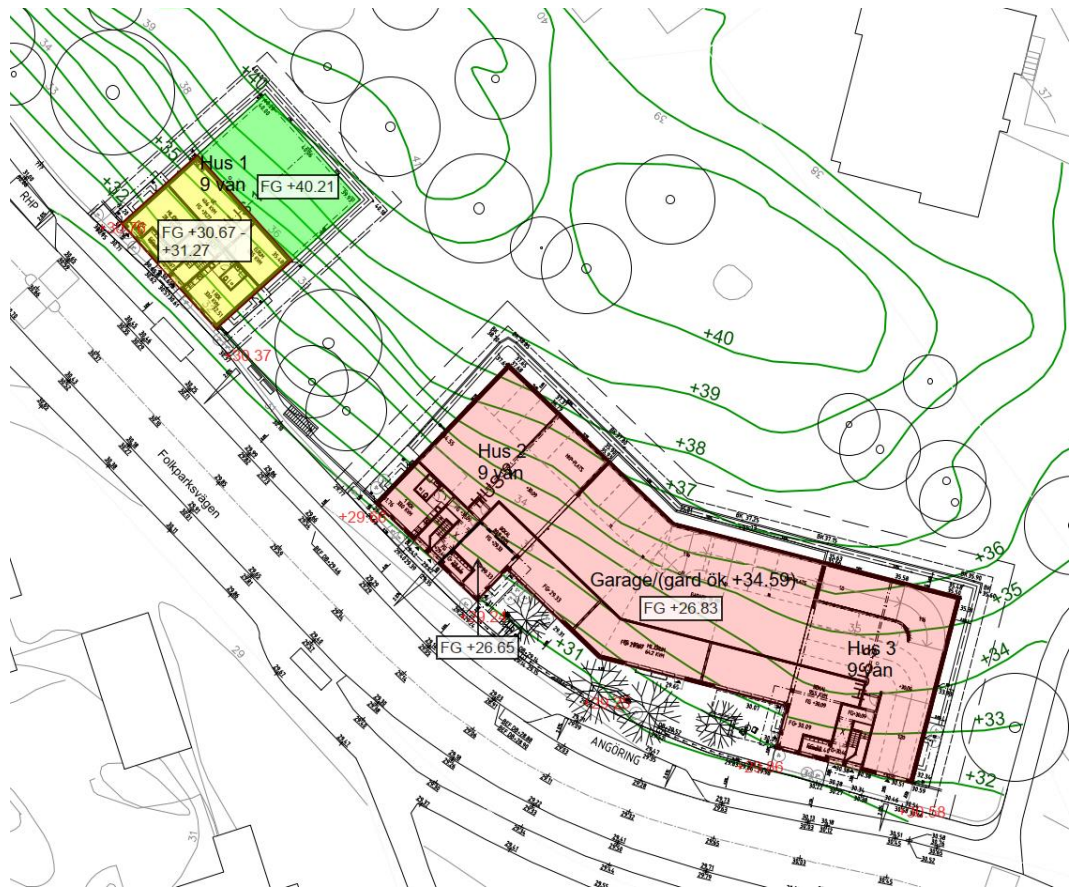
Figur 2. Planerad utformning inom enligt situationsplan, daterad 2024-02-14. Befintlig marknivå redovisas med grönfärgade linjer. Planerad gatunivå redovisas med röda siffror.
