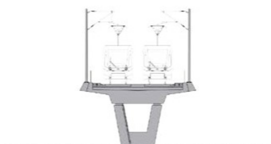
Dubbelsidig kontaktledningsstolpe med bärlina på bro (B)
