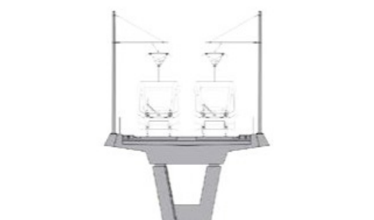
Dubbelsidig kontaktledningsstolpe på bro (C)
