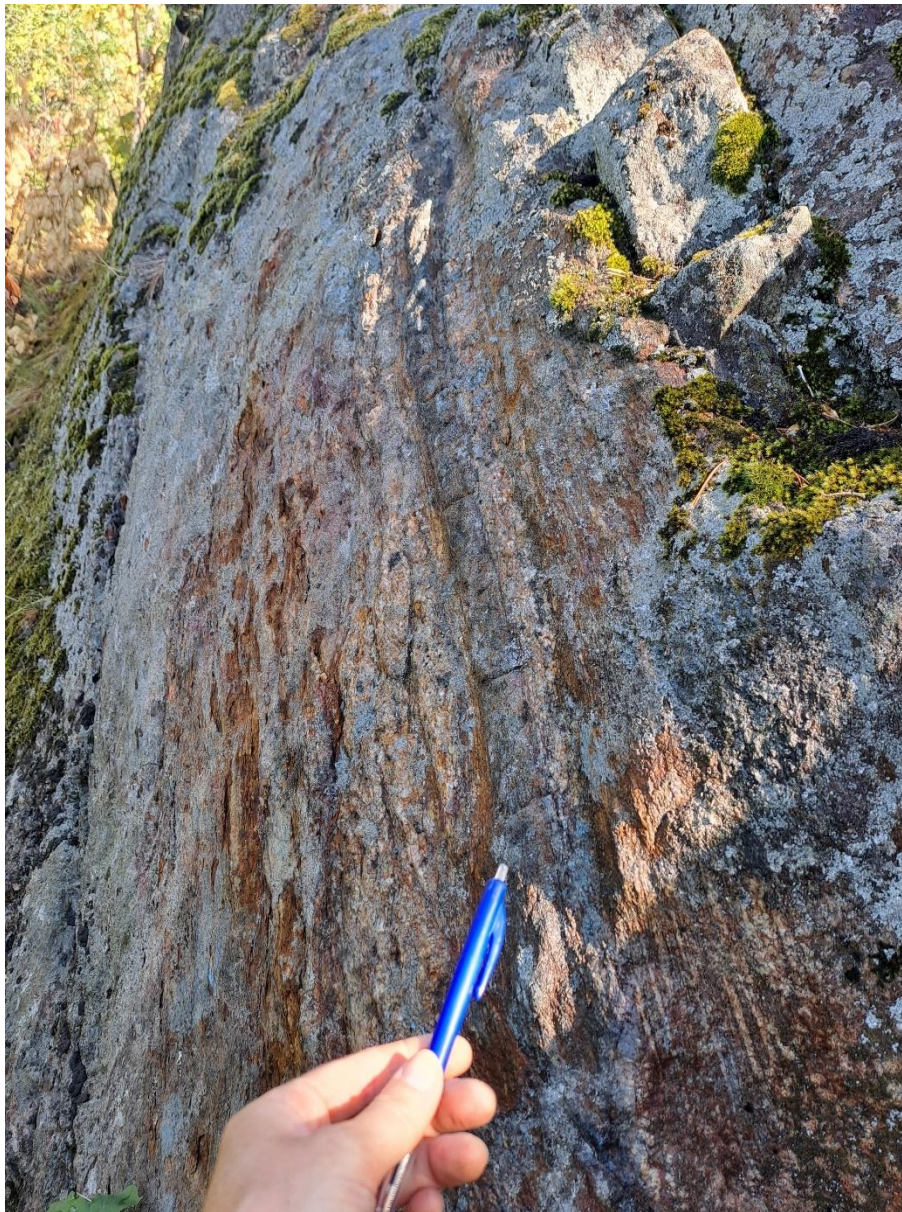
Figur 3. Rost längs med bergets foliation (bandning) i delområde 2s. Pennan i bild är endast för skalreferens.
