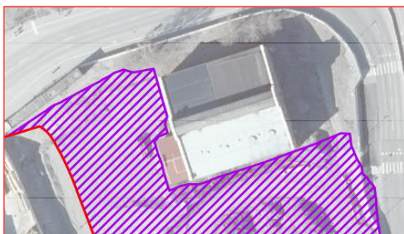
Figur 7. Utförd markrening genom schakt till lägsta grundvattennivå kring Hus 22 markerad med lila linjeraster. Yttre lila linje visar slänkrön.
