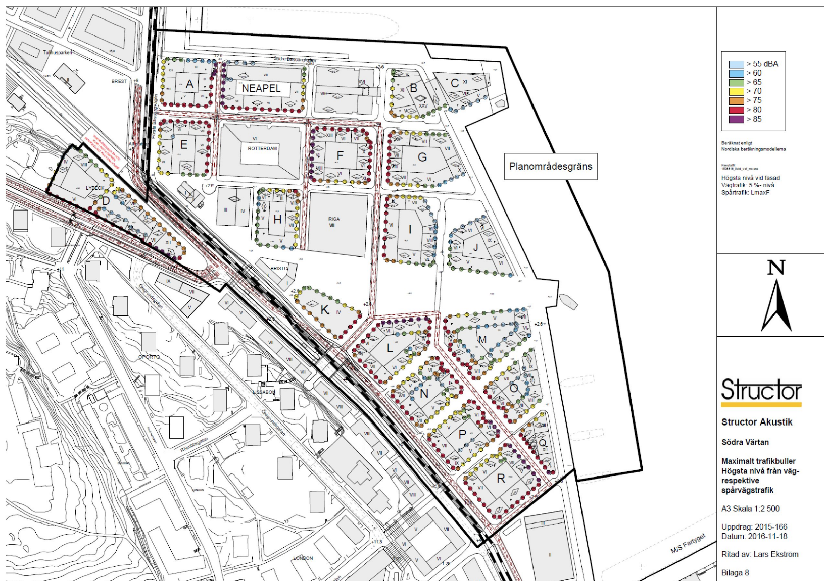
Figur 16. Figuren illustrerar resultatet från den bullerutredning som är genomförd för Södra Värtan för maximalt spår- och vägtrafikbuller. Höga nivåer uppmätta på de större gatorna, i de flesta fall överstigs ej 70 dB(A) på uteplatser och tysta sidor. Från 2016-11-18 (Structor, 2016).
