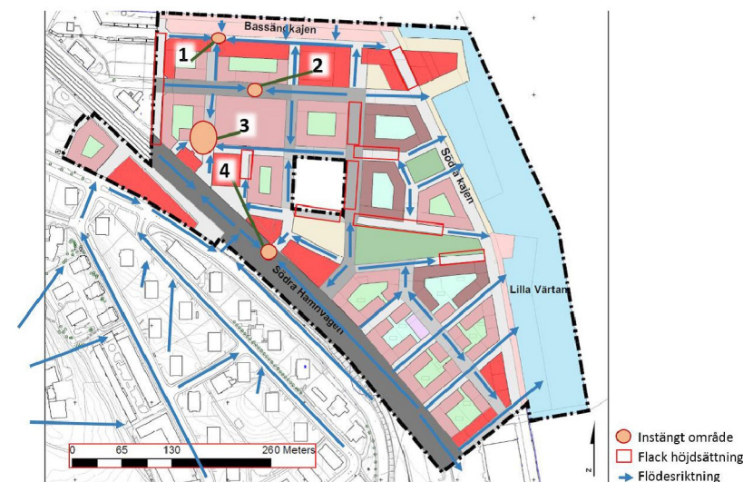
Figur 6. Avrinningsriktningar vid extremregn. Blå pilar visar på riktning, röd linje visar på flack höjdsättning och orangea fyllda cirklar visar på instängda områden. Lågpunkterna är numrerade 1, 2, 3 och 4 (Sweco, 2016).
