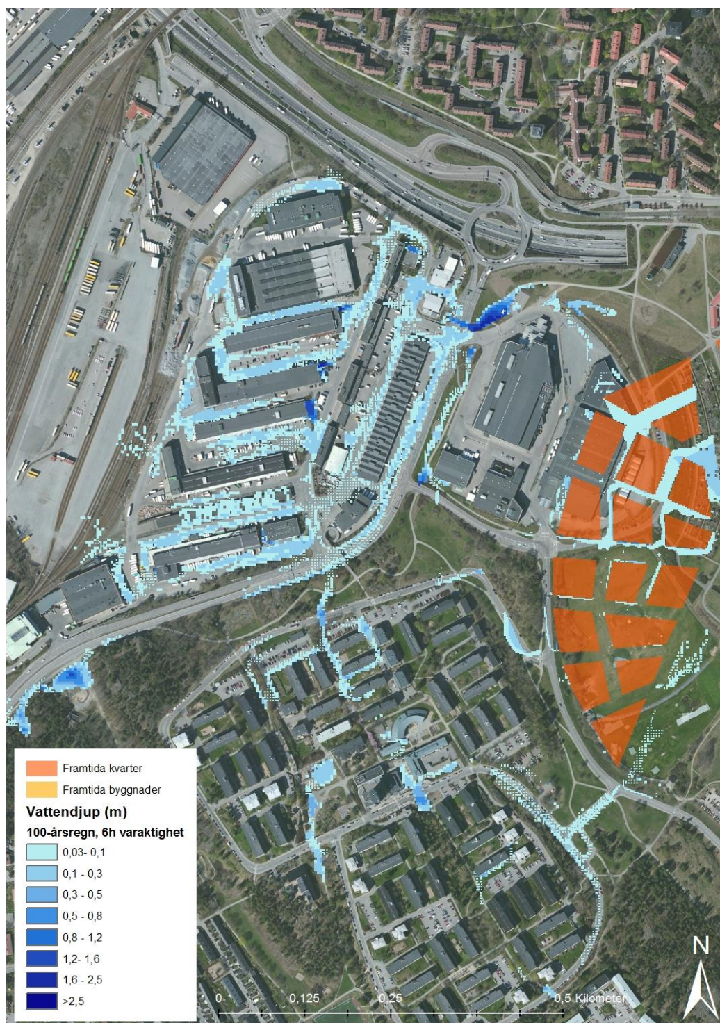
Figur 5. Maximalt vattendjup vid belastning av 100-årsregn, västra modellområdet.
