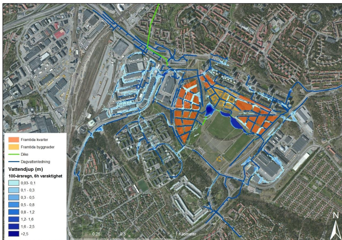
Figur 3. Maximalt vattendjup vid belastning av 100-årsregn, översikt.
