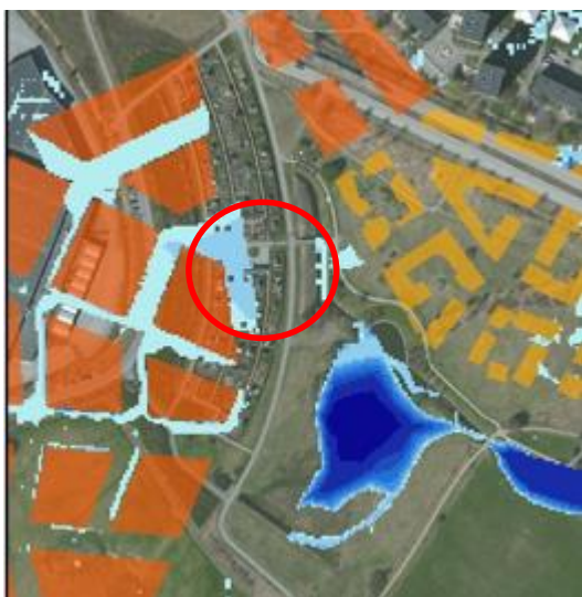
Figur 7. Simuleringsresultaten visar att vatten ställer sig mot en byggnad inom markerat område. Förmodligen blir området instängt till följd av att interpoleringen av terrängmodellen är gjord på grovt underlag.
