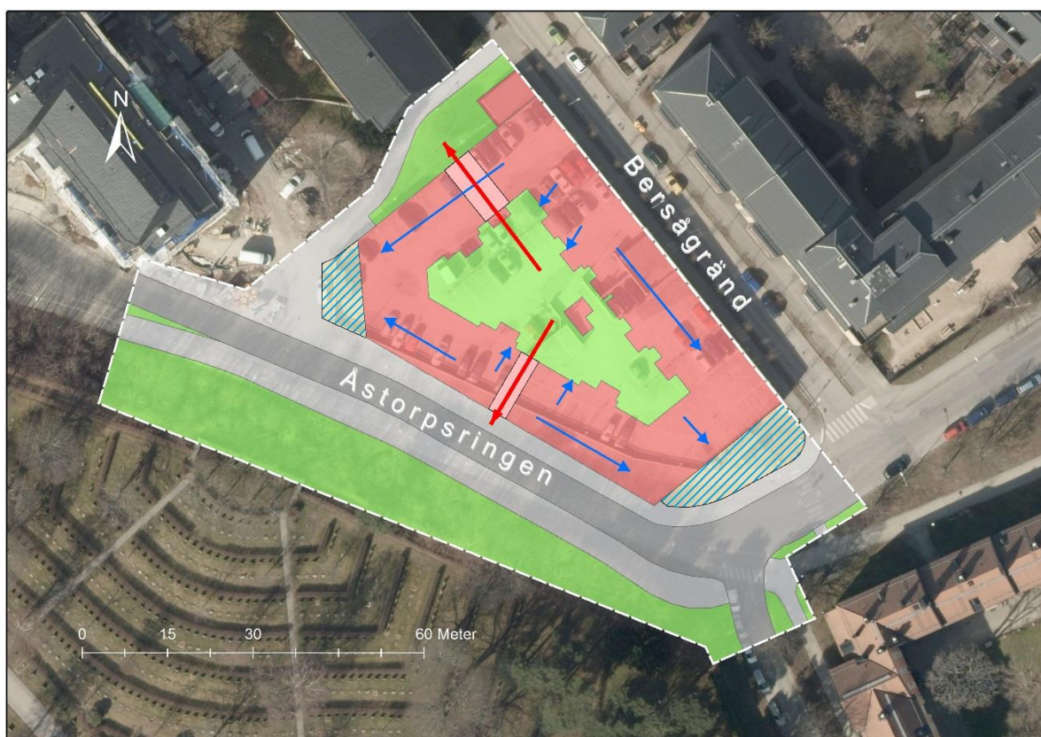
Figur 5-1. Principskiss med ungefärlig placering av makadammagasin (blåstreckad yta) under byggnadens entrétytor. De röda pilarna visar ytlig avrinningsväg för dagvatten genom portikerna (ljusare markering i huskroppen) vid extremregn.
