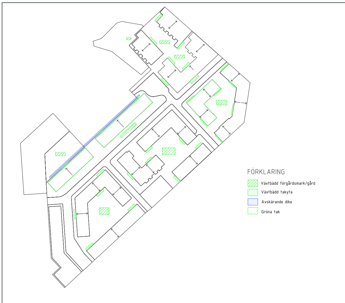
Figur 11. Placering och ytbehov för dagvattenfördröjning. Total yta för respektive kvarters olika fördröjnings- och reningsåtgärder ses i figuren. Exakt placering av växtbäddar är ej fastställd, men rekommenderas vid utkastare i anslutning till takytorna.
