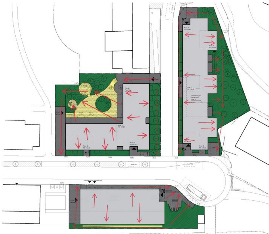
Figur 15. Redovisning av avrinningsvägar vid ett skyfall inom utredningsområdet. Avrinningen presenteras med röda pilar.
