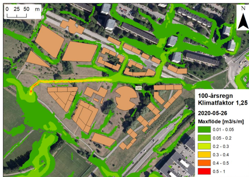
Figur 17. Maximalt flöde (m3/s/m) vid 100-årsregn med klimatkfaktor 1,25. Orangea polygoner visar nya byggnader/kvarter.
