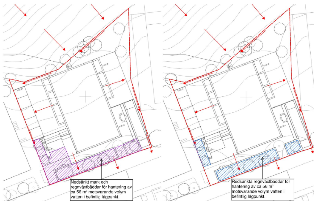
Figur 10. Exempel nedsänkta ytor för ny lågpunkt med area 210 m 2 och djup 0,25 m (t v) och exempel nedsänkta regnväxtbäddar med area 120 m 2 och djup 0,45 m (t h) för hantering av skyfall motsvarande befintlig lågpunkt som byggs bort vid planerad bebyggelse.
