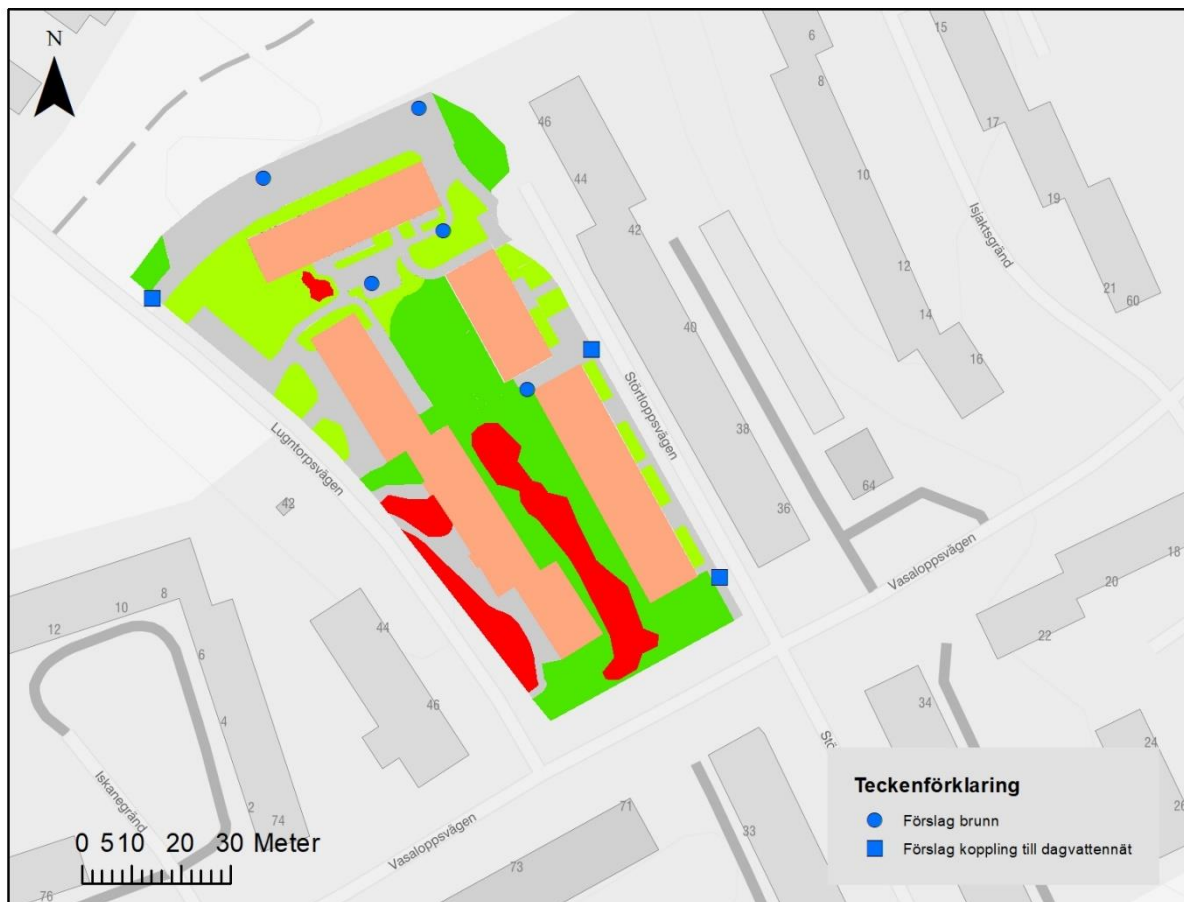
Figur 6-4. Förslag till placering av dagvattenlösningar i form av skelettjord, makadamdike och svackdike som föreslås inom planområdet. Observera att ytorna är en illustration av föreslagna dagvattenlösningars ytanspråk och att andra placeringar är möjliga.
