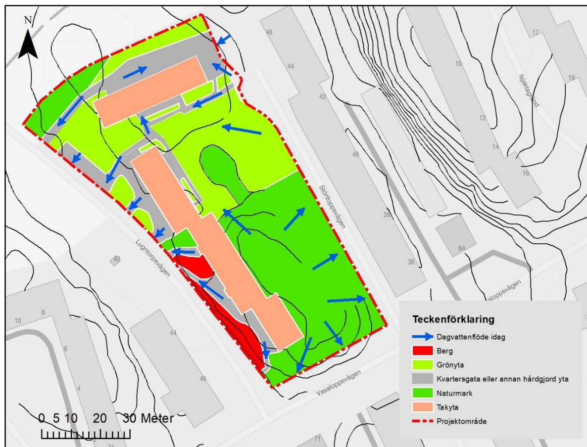
Figur 3-3. Ytavrinning, enligt befintlig markanvändning inom utredningsområdet.
