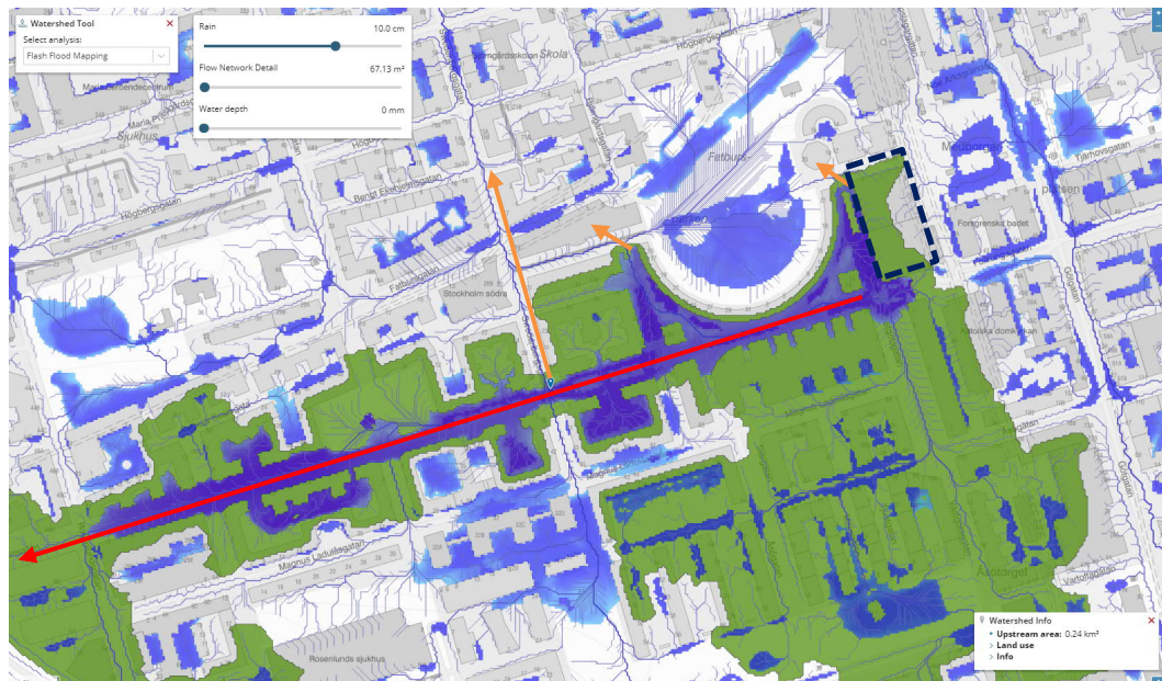
Figur 12b – Avrinningsområde vid skyfall (grön), översvämningssområde som fylls upp (blått) och sekundära rinnvägar samt trösklar med ytliga utlopp (orange) och ledningsnåtsutlopp (rött)
