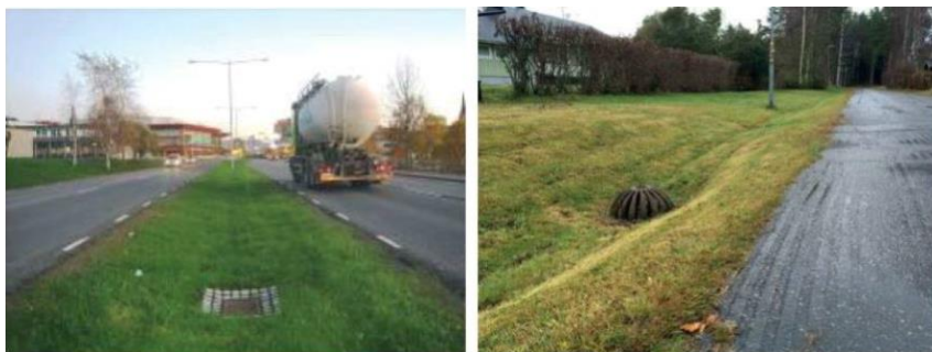
Figur 24. Två exempel på svackdiken. (Svenskt Vatten Utveckling, 2019)
