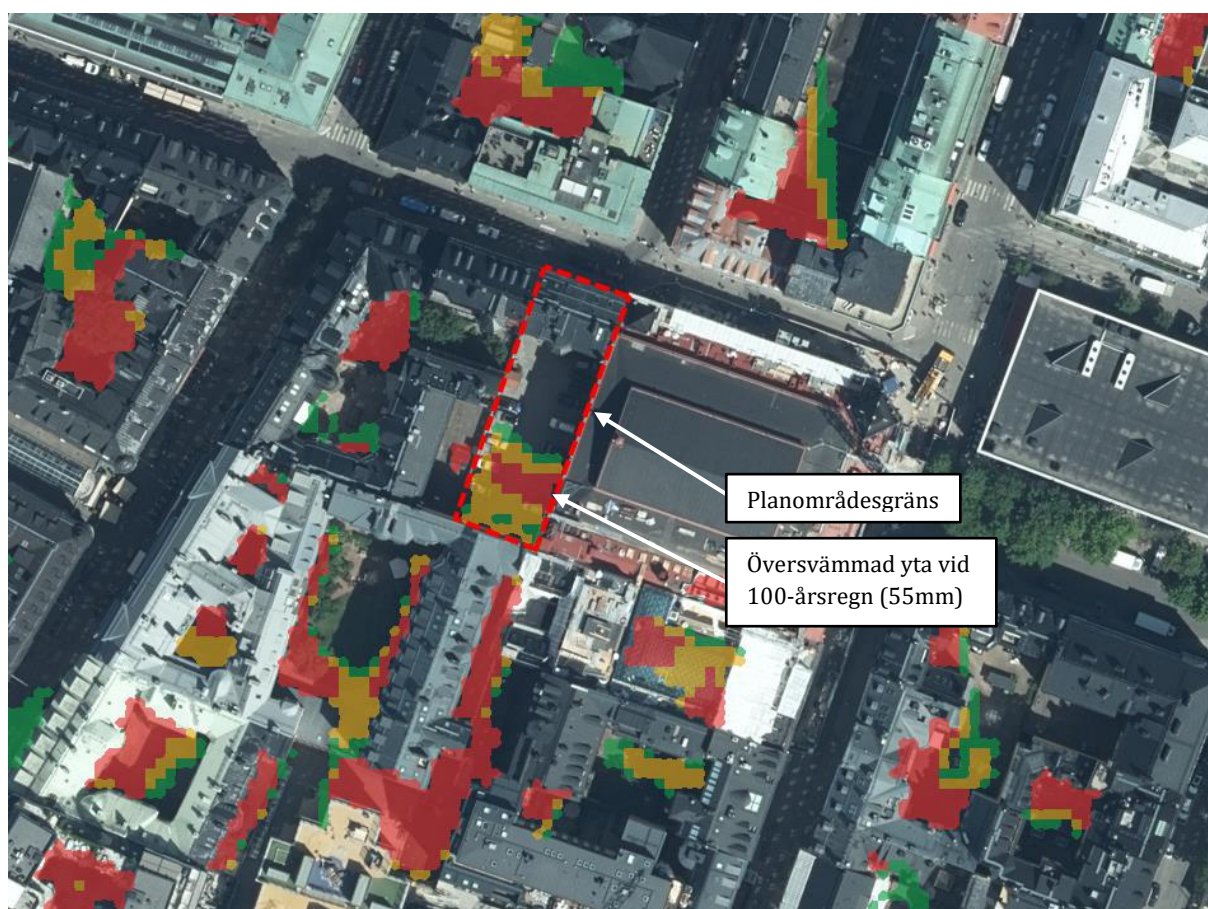
Bild 14, Utbredning av ytliga dämningar vid 55mm nederbörd. Dämningarna är illustrerade i färger som anger dämningsdjup där grön=<10cm, gul=10-20cm och röd=>20cm (Scalgo Live, Marktema 2021).
