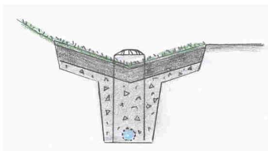
Figur 15. Makadamfyllt dike (krossdike) med dräneringsledning och kupolsil för bräddning av vatten.
