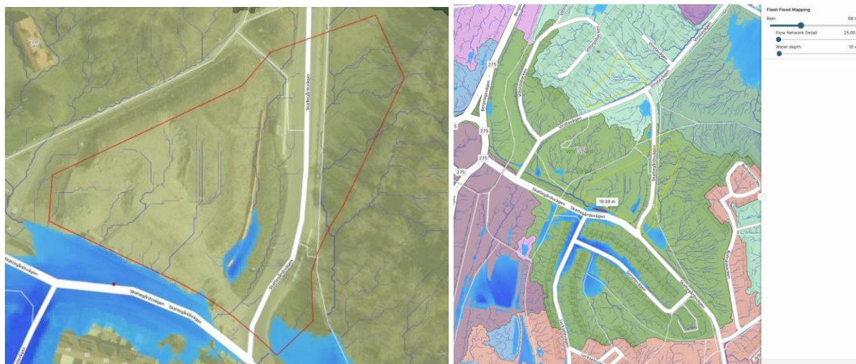
Figur 13 Lågpunkter och skyfallsvägar (t.v.) (Scalgo Live) samt avrinningsområde vid 68 mm nederbörd (100-årsregn 60 min varaktighet) (t.h.)
