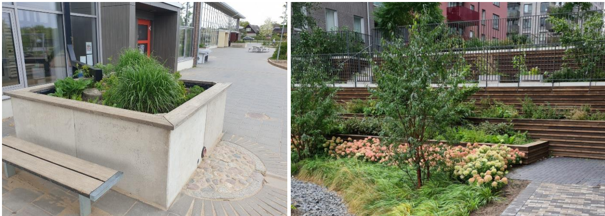
Figur 24 Upphöjd växtbädd placerad från fasad, med erosionsskydd, som tar emot takvatten och släpper ut vattnet yttligt till ränna (Dalby) (t.v.). T.h. visas terrasserade växtbäddar i trapp som kan ta emot dagvatten från hårdgjord gårdsmark (Hammarby Sjöstad)
