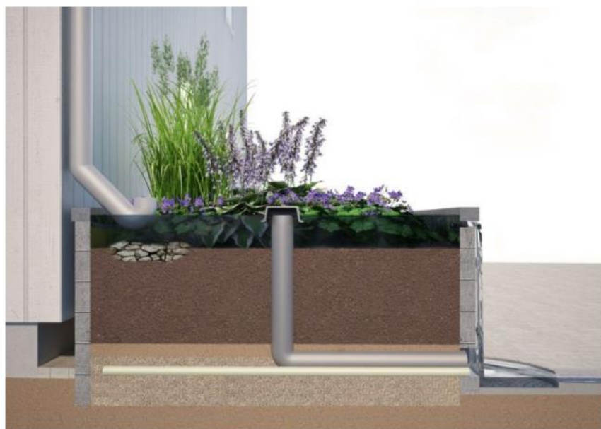
Figur 8. Principskiss för upphöjd biofilterkonstruktion. (Bildkälla: Grågröna systemlösningar för hållbara städer, Inventering av dagvattenlösningar för urbana miljöer, Vinnova 2014.)
