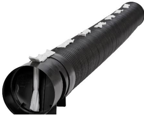
Bild 2. Dräneringsrör av typen Savaq 160 som består av ett sektionindelad rörsystem som reducerar vattenflödet och med hjälp av en väv som kapillärt leder upp vattnet ur röret bevattnar ovanliggande jord. (Bild från tillverkaren.)
