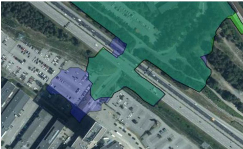
Figur 4 Avrinningsområde på Stockholmssidan före och efter utbyggnad. Grön yta visar avrinningsområdet före utbyggnad, lila ytor visar ytor som tillkommer efter ombyggnad. Bild från PM Skyfallsmodellering, Sweco 2020-10-16, rev 2021-06-23.
