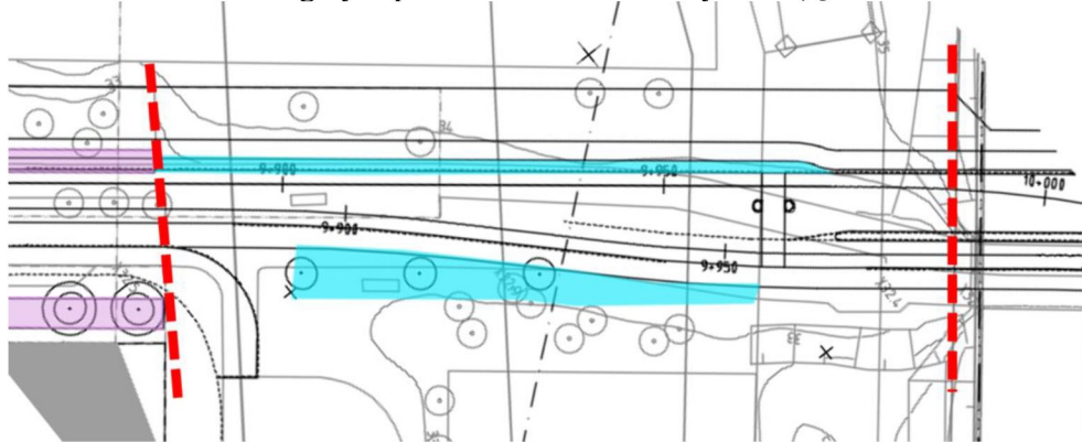
Figur 13 Möjlig fördröjnings- och reningsåtgärd. Turkos - yta för åtgärd (plantering/raingarden). Röd streckad linje – gräns för yta från vilken dagvatten kan ledas till åtgärden.
