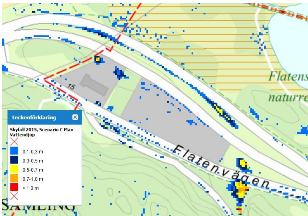
Figur 4 Skyfallskartering utförd av Stockholm stad. Visar att det finns en lågpunkt sydost om planområdet, på båda sidor om Flatenvägen.
