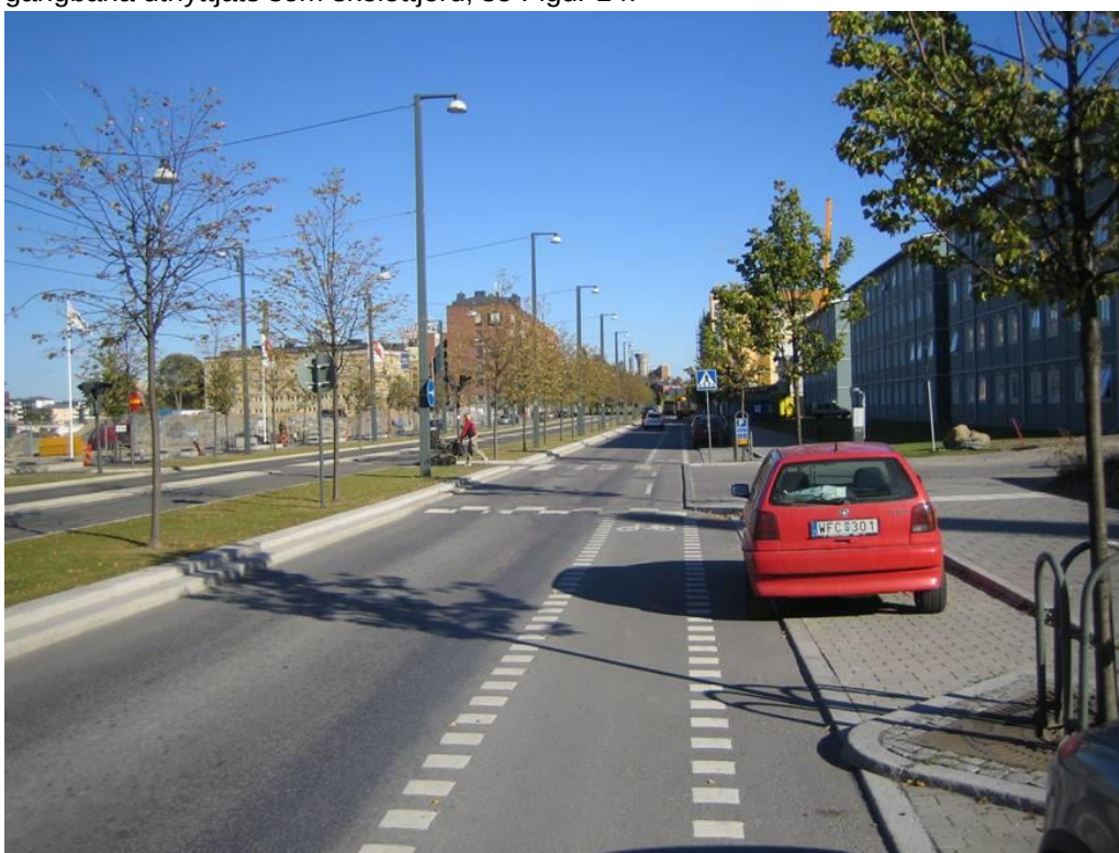
Figur 14 Figuren visar att träden till höger, som växer i skelettjord och får dagvatten, fortfarande har gröna blad jämfört med de träd som växer till vänster där det inte är skelettjord.
