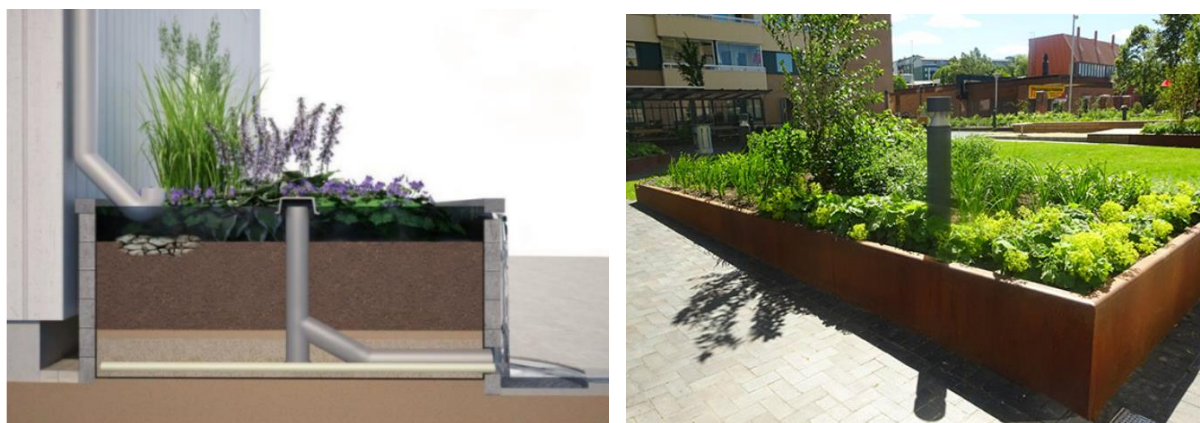
Figur 11. Tvärsnitt av ett exempel på en upphöjd växtbädd till vänster och i verkligheten (Källa: VegTech och Bara Mineraler)
