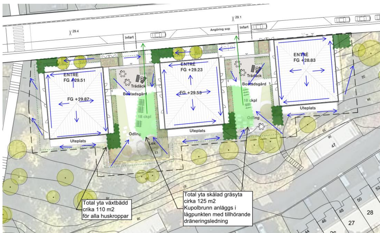
Figur 10. Principlösning för dagvattenhantering för kvarteret. Totalt magasineras cirka 35 m 3 . Mörkgröna ytor motsvarar yta för växtbädd, ljusgröna ytor indikerar yta för skålad gräsyta.
