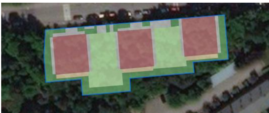
Figur 8. Kartering av planerad exploatering. Grönt representerar genomsläppliga ytor, ljusgrönt innergårdar. Grått representerar hårddgjorda ytor och rött takytor.
