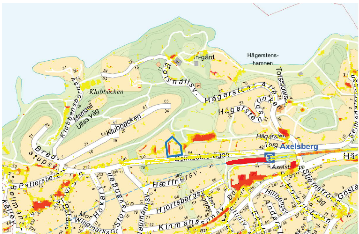
Figur 7 Röda områden visar var vatten skulle kunna samlas vid extremt skyfall (100-årsregn). Bild från översvämningskartering av Stockholm Vatten och Avfall.
