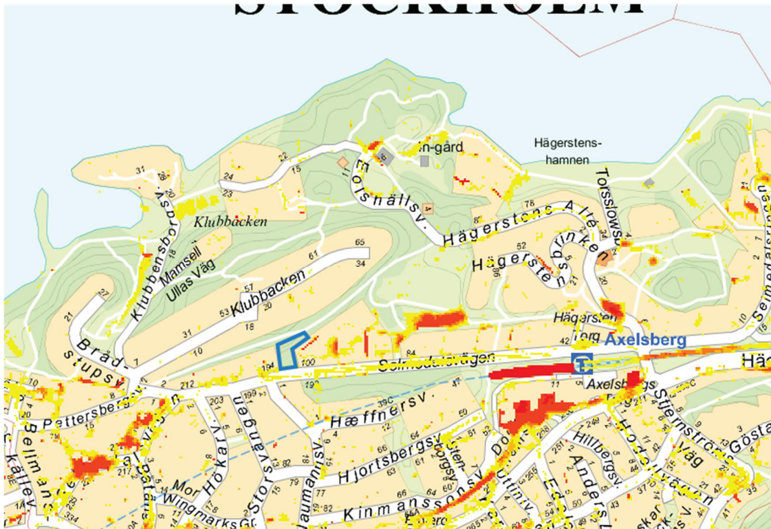
Fig. 6 Röda områden visar var vatten skulle kunna samlas vid extremt skyfall (100-årsregn). Bild från översvämningskartering av Stockholm Vatten och Avfall.
