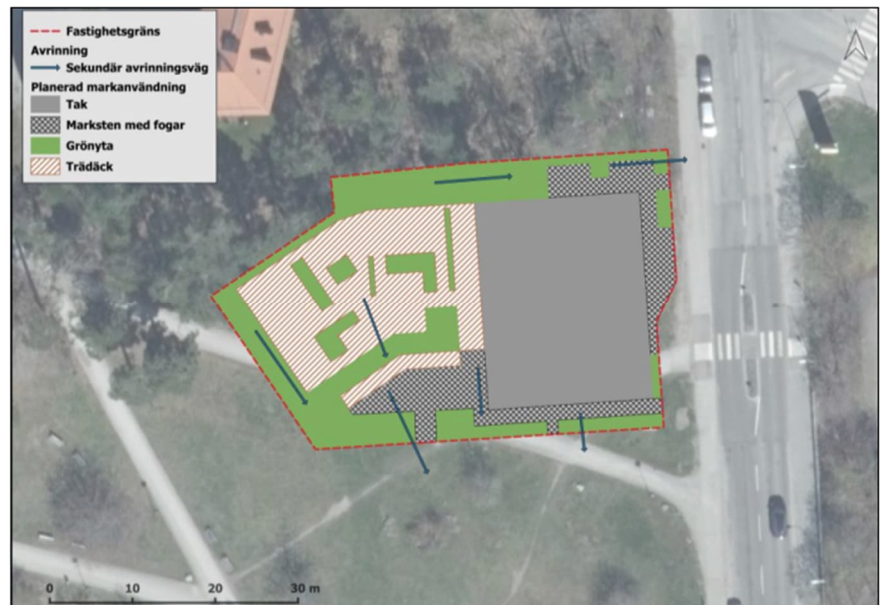
Figur 46 Föreslagna avrinningsvägar för kvarter G (Rejlers, 2024).
