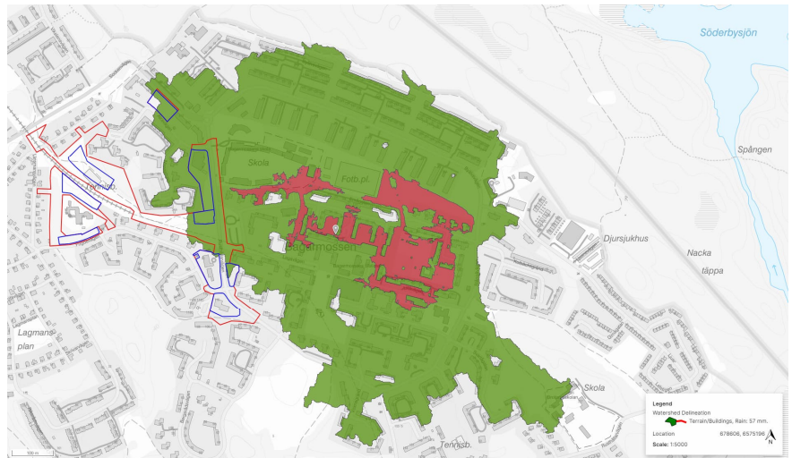
Figur 13 Avrinningsområdet (grönt) vid 56 mm regn till lågpunkten i öster (röd). Planområdesgräns i rött och kvartersmarksgrens i blått. (ScalcoLive, 2024)
