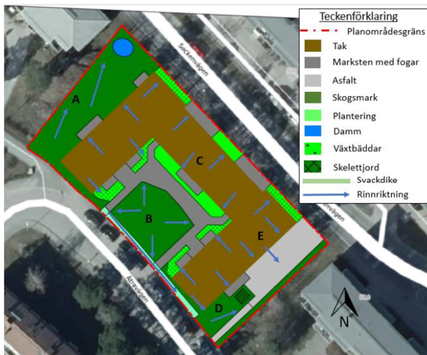
Figur 53 Föreslagen markanvändning och dagvattenlösningar i kvarter D (Rejlers, 2024).
