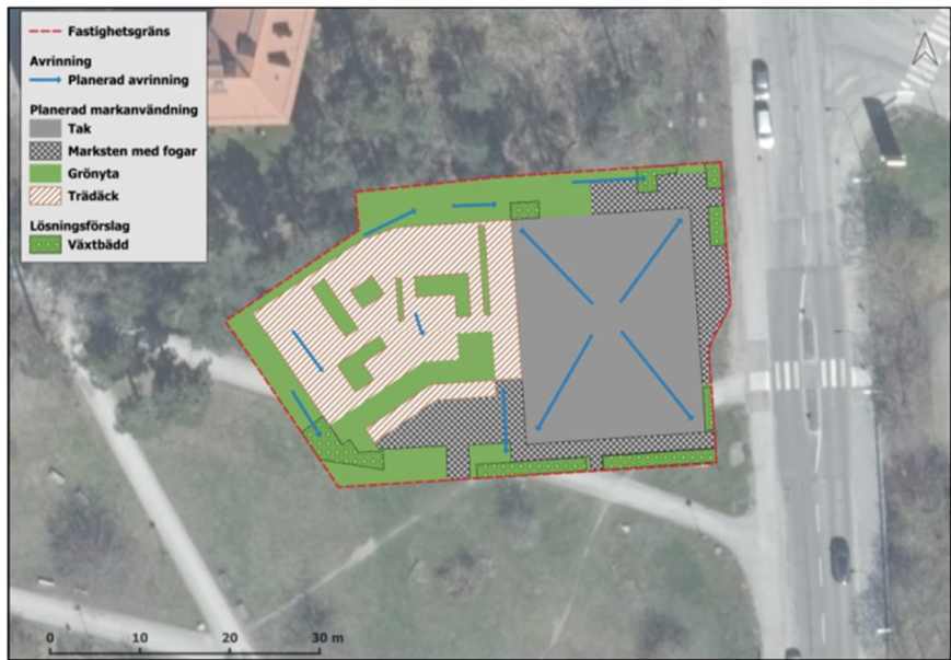
Figur 56 Föreslagen markanvändning och dagvattenlösningar kvarter G (Rejlers, 2024).
