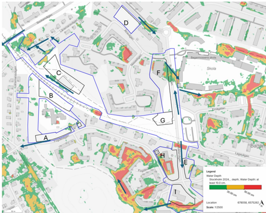
Figur 15. Stockholms stads skyfallsmodellering 2024. Maxdjup vid modellerat 100-årsregn inkl klimatfaktor 1,25. (Stockholms stad, 2024). Kvartersmark markerad med svarta linjer och planområdesgräns i blått. Rinnvägar markerade med blå pilar.
