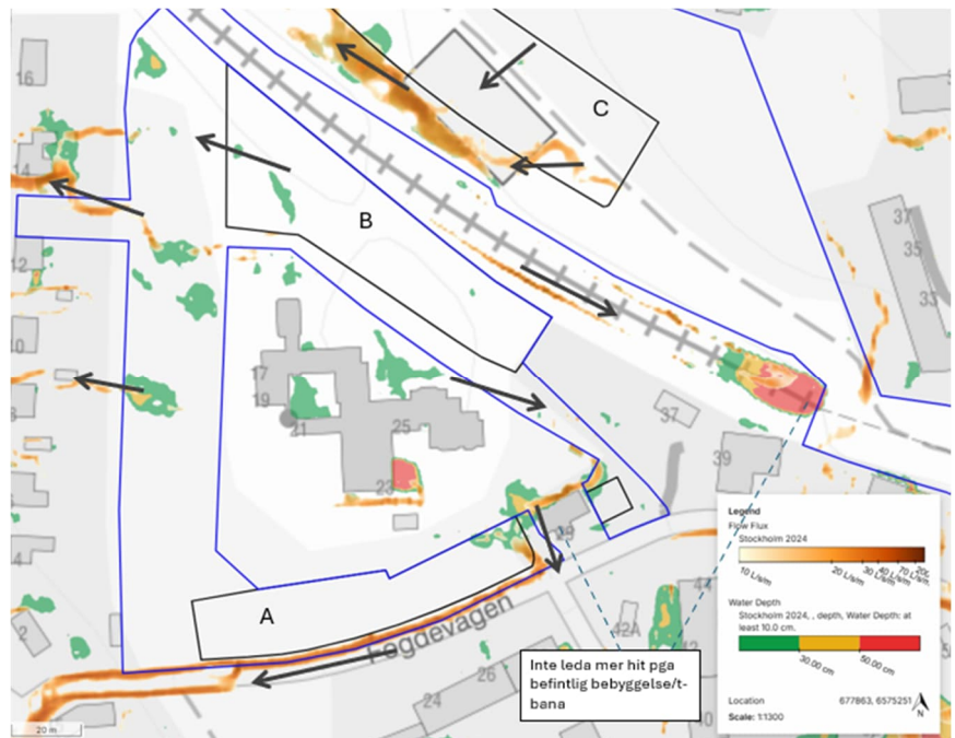
Figur 16. Instängda områden och rinnvägar i delområde A, B samt kringliggande allmän platsmark. Maxflöden och maxvolymen vid skyfall från Stockholms stads skyfallsmodell 2024. Kvartersmark markerad med svart linje och planområdesgräns blå linje. Svarta pilar visar flödesriktning för rinnvägarna.
