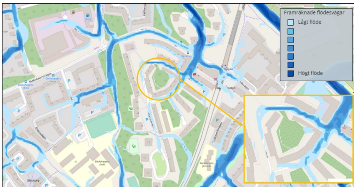
Figur 16. SVOA:s skyfallsmodell med fokus på flödesvägar. Förstorad bild över planområde syns i nedre högra hörnet (Stockholm Vatten och Avfall, 2020 ).
