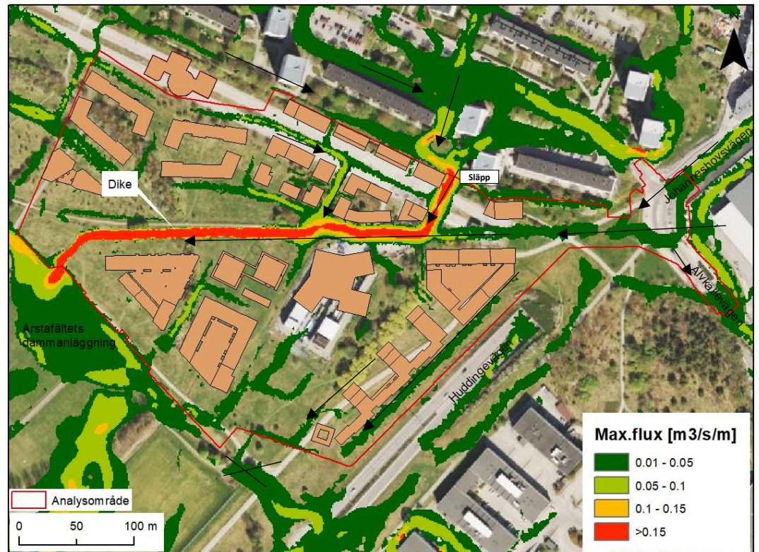
Figur 21. Maximalt flöde (m 3 /s/m) vid 100-årsregn med klimatfaktor 1,25. Orangea polygoner visar nya byggnader. Stora flödesvägar såsom diket rekommenderas hållas fi för att undvika dämningar. Röda linjen motsvarar området där höjdsättningen har ändrats inom etapp 4. Svart kryss markerar triangeltomtens läge.
