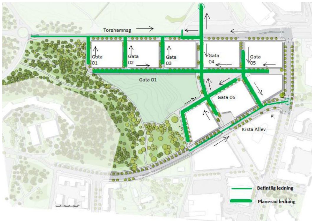
Figur 6 Befintliga och planerade ledningar enligt PM yttre VA-ledningar, WSP 2016. Anslutning till dagvattentunneln mot edsviken är föreslagen vid platsen som markerats med en cirkel.
