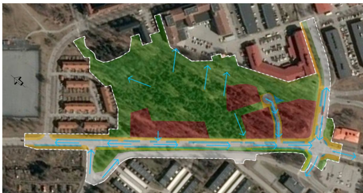
Figur 6-3. Översiktliga flödesvägar för ytavrinning vid extrema regn i planerad situation. Flödena som fortsätter västerut och söderut från utredningsområdet (neråt och åt höger i bilden) hamnar i lågpunkterna vid Gråhundvägen och under viadukten.
