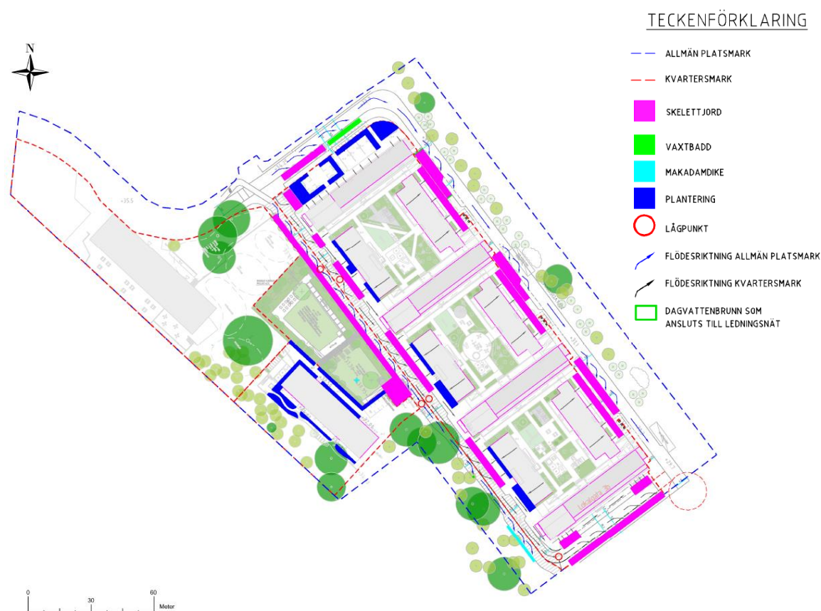
Figur 32. Dagvattenhantering i Vitsand Norra i form av skelettjordar, växtbädd och makadamdike. Skalan i figuren gäller ej.
