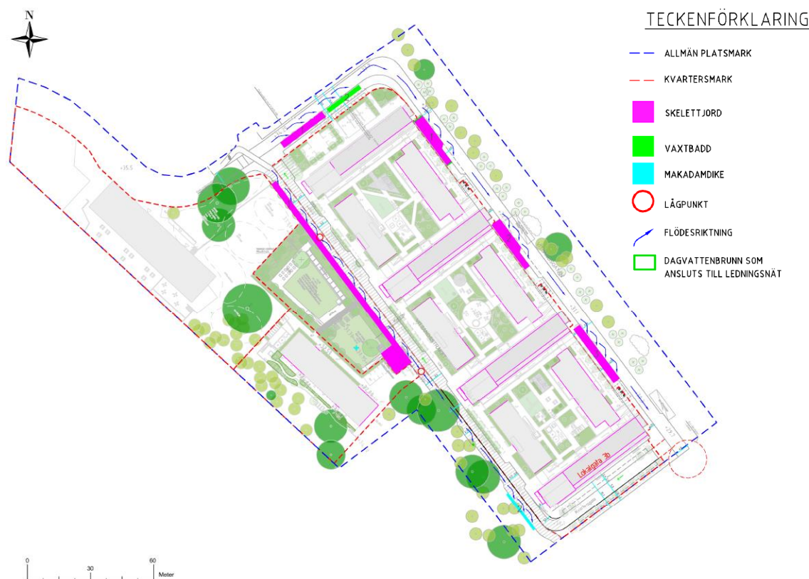
Figur 17. Dagvattenhantering i Vitsand Norra i form av skelettjordar, växtbädd och makadamdike. Skalan i figuren gäller ej.
