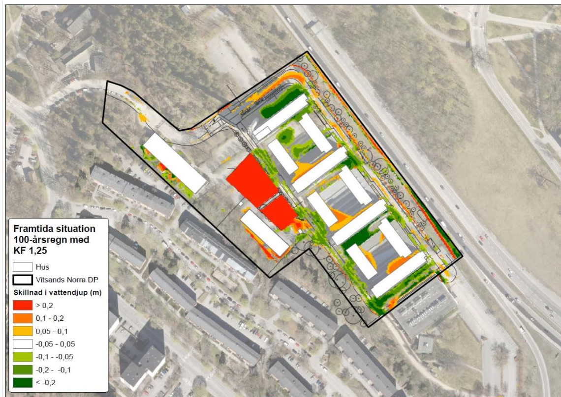
Figur 31. Beräknad skillnad i vattendjup (m) mellan befintlig och framtida situation. Ortofoto 2016, Stockholms stads WMS-tjänst.
