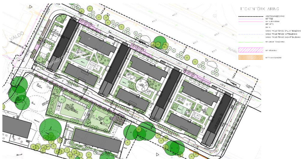
Figur 11. Förslag på dagvattenledningar för att möjliggöra anslutningar av dagvattenanläggningar enligt systemhandlingsskiss (Ramboll, arbetsmaterial R-51-1-100, 2020-12-22). För detaljer hänvisas till pågående systemhandling.
