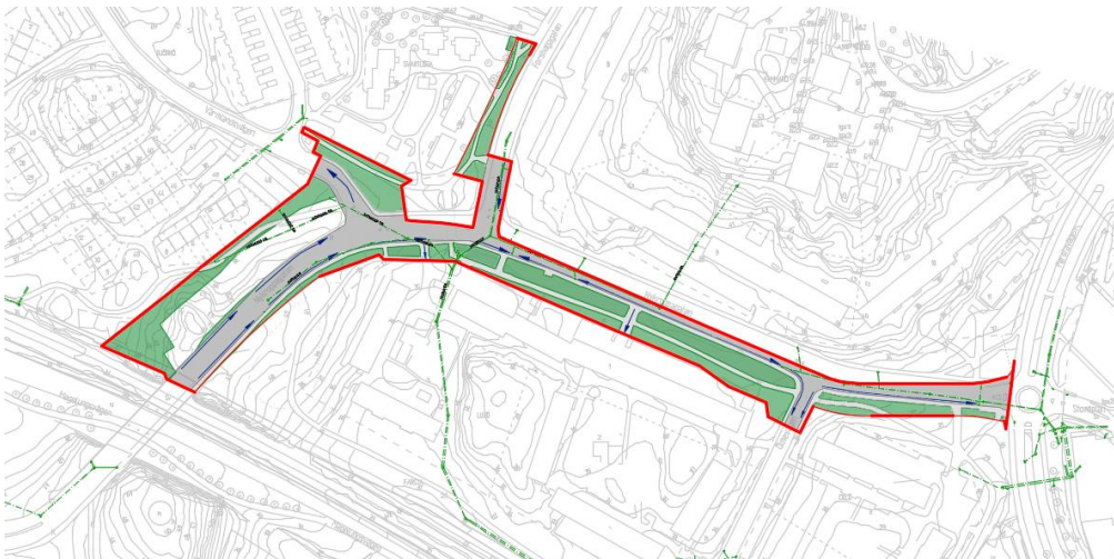
Figur 5. Befintlig avvattning och dagvattenledningar inom utredningsområdet. Utredningsområdesgränsen för allmän platsmark är markerad med rött.
