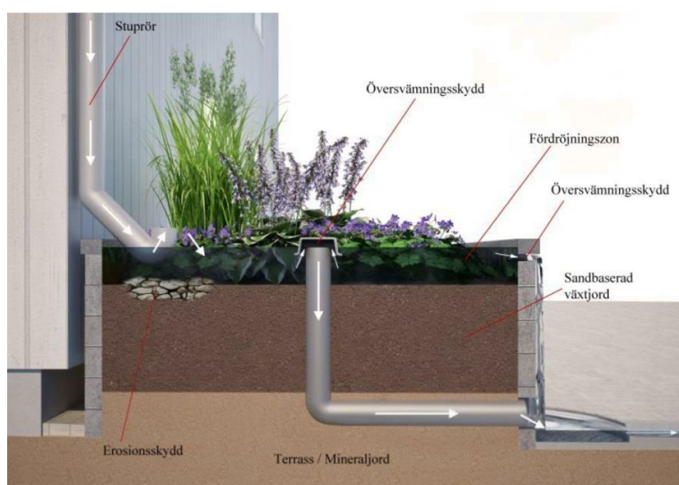
Figur 36 Principskiss för biofilter uppbyggd konstruktion. (Bildkälla: Grågröna systemlösningar för hållbara städer, Inventering av dagvattenlösningar för urbana miljöer, Vinnova 2014.)
