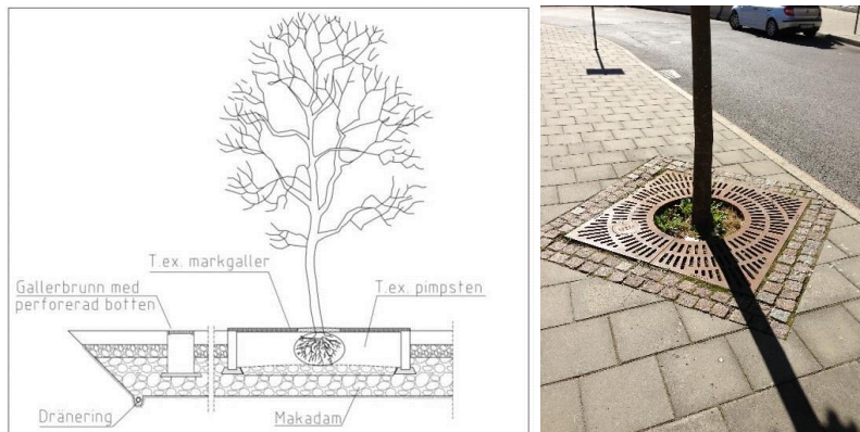
Figur 16. Träd i skelettjord. Konceptskiss från Malmö stads tekniska handbok (t.v.).
