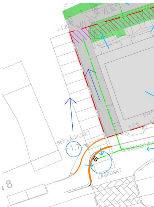
Figur 24. Lokalgatan förses med kantsten och dagvattenbrunn som stoppar upp och avleder dagvattnet. Vid extrema regn kan dock vatten stiga i gatans lågpunkt. Vattnet breder ut sig i lokalgatan, som har en viss magasinvolym, innan det rinner över kantstenen (orange linje) mot Masugnen 8.
