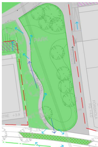
Figur 23. Systemlösning för parkområdet. Gångstråket lutar ut mot grönytor för fördröjning och rening av dagvattnet. Se Bilaga 1 för större format.
