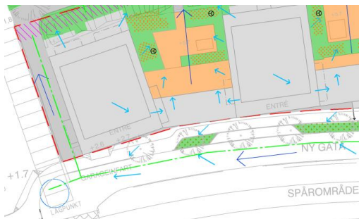
Figur 22. Norra delen av lokalgatan längs med Karlsbodavägen. Dagvattnet leds till växtbäddar för rening och fördröjning. Bräddledningar från växtbäddarna ansluts till nya dagvattenledningar i gatan. Se Bilaga 1 för större format.
