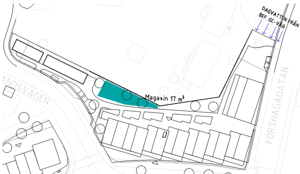
Figur 11. Förslag på dagvattenhantering för område A, alternativ 2. Ett underjordiskt magasin med kapacitet att fördröja den erforderliga volymen 17 m 3 anläggs på del av gården om ej ligger på bjälklag.
