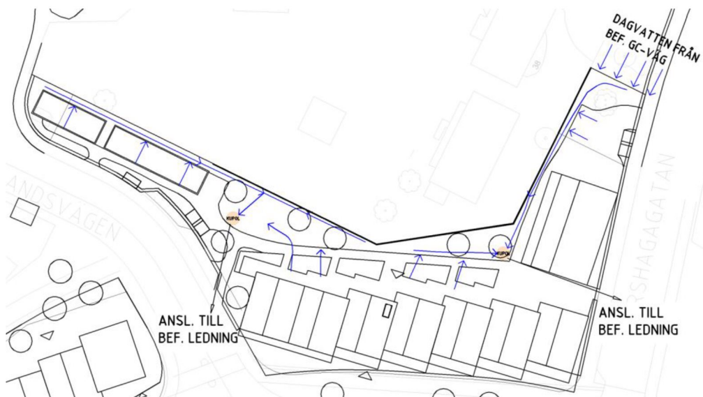
Figur 9. Förslag på dagvattenhantering för område A, alternativ 1. Öppen dagvattenhantering. Avrinningsstråk i blått och kupolsilar i orange.
