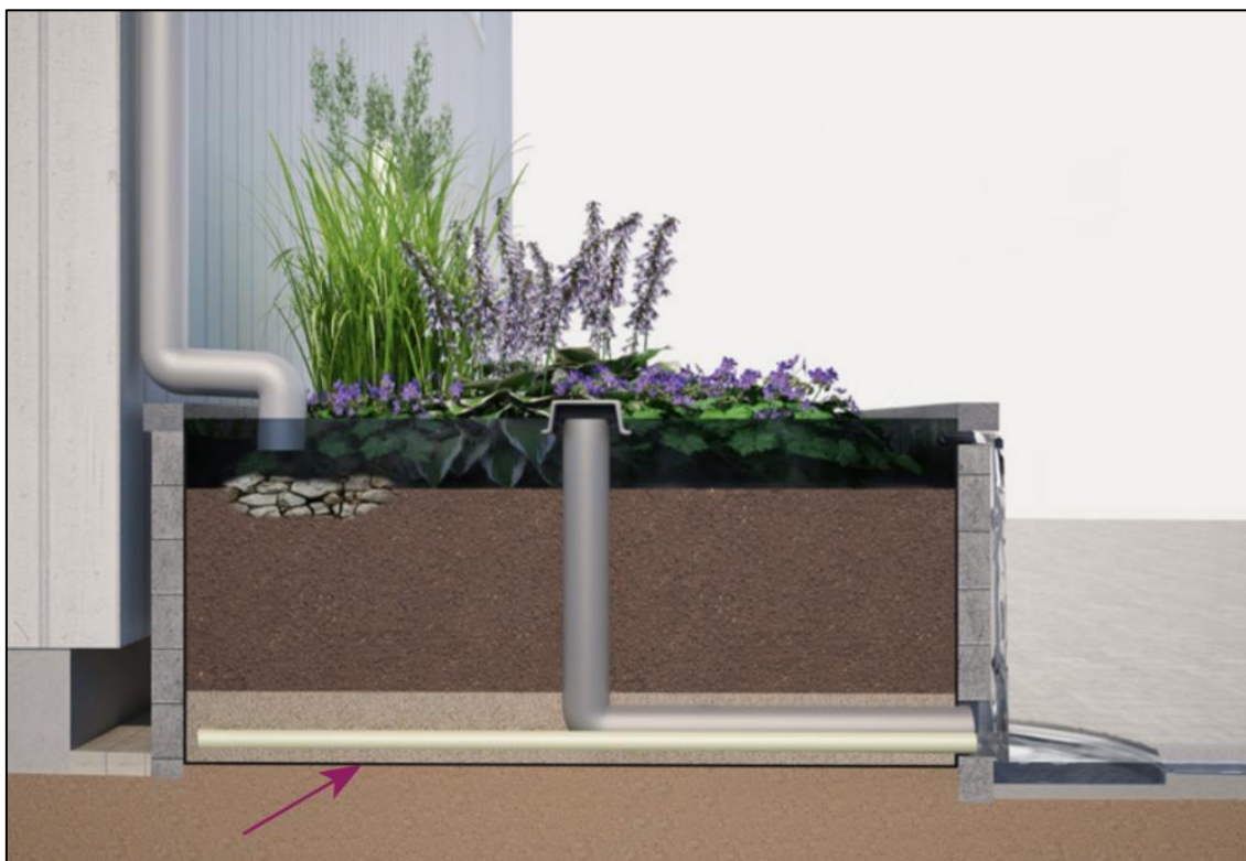
Figur 9-1. Växtbädd med underliggande tätduk som förhindrar vidare infiltration till underliggande mark. För det aktuella fallet föreslås en växtbädd där överytan är i nivå med omgivande mark och utan en övre fördröjningszon. Vatten avleds via dräneringsledning för att undvika att vatten blir stående i anläggningen under längre tid. Illustration: Tengbom, hämtad från Movium Fakta (2015).
