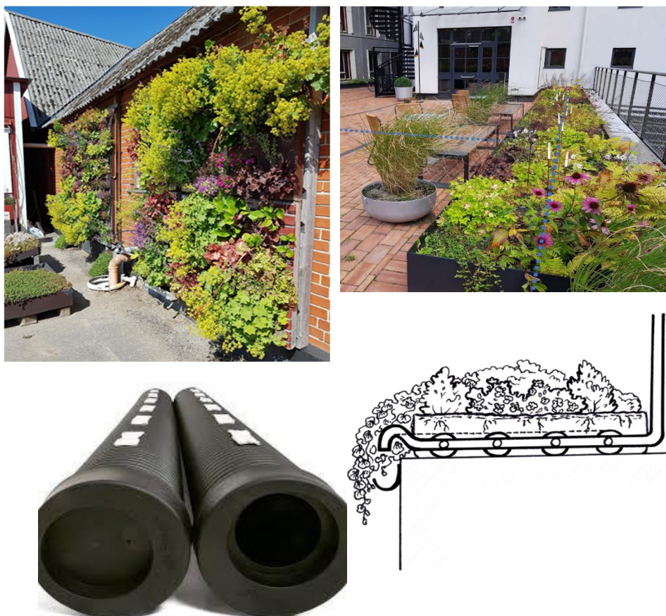
Figur 20 - Uppe till vänster: Bevattningssystem för väggperenner (bild:Sweco). Uppe till höger: Blique by Nobis, Blå streckad linje under plantering är tex. ett Savaq-system (bild: Sweco). Nere till vänster: Savaq-system (Terregio.se) Bevattningssystem som utnyttjar kapillarkrafterna. Nere till höger: Princip bevattningssystem under upphöjd plantering (Terregio.se).
