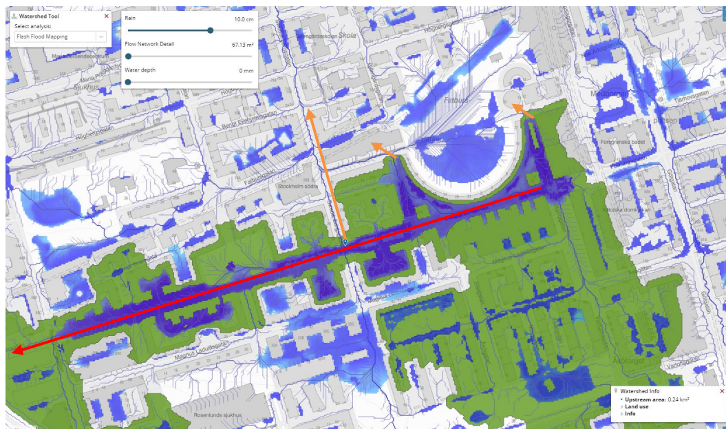
Figur 12b – Avrinningsområde vid skyfall (grön), översvämningssområde som fylls upp (blått) och sekundära rinnvägar samt trösklar med ytliga utlopp (orange) och ledningsnätutlopp (rött)
