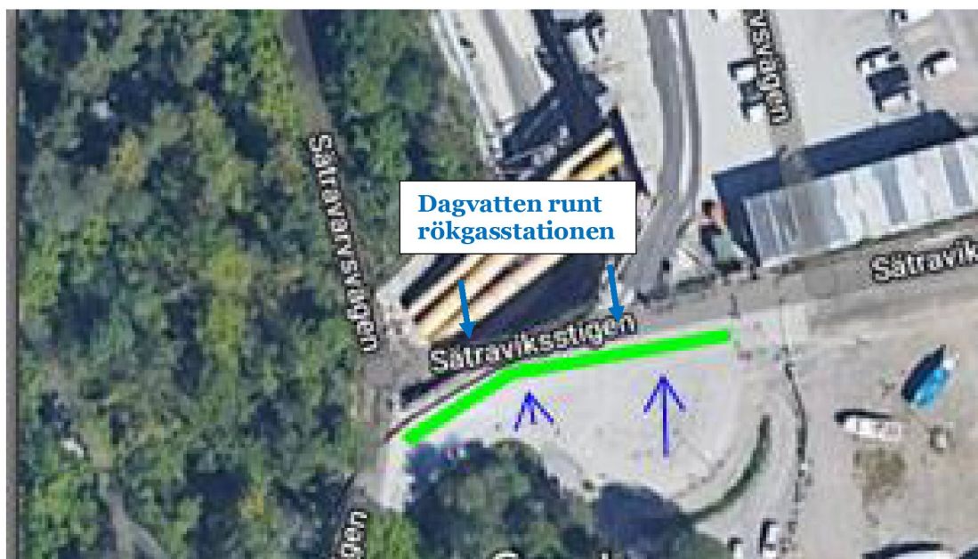
Figur 3: skiss för dagvattenhantering i delområde 1. Grön linje illustrerar föreslaget makadamdike.
