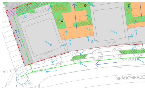
Figur 20. Norra delen av lokalgatan längs med Karlsbodavägen. Dagvattnet leds till växtbäddar för rening och fördröjning. Bräddledningar från växtbäddarna ansluts till nya dagvattenledningar i gatan. Se Bilaga 1 för större format.
