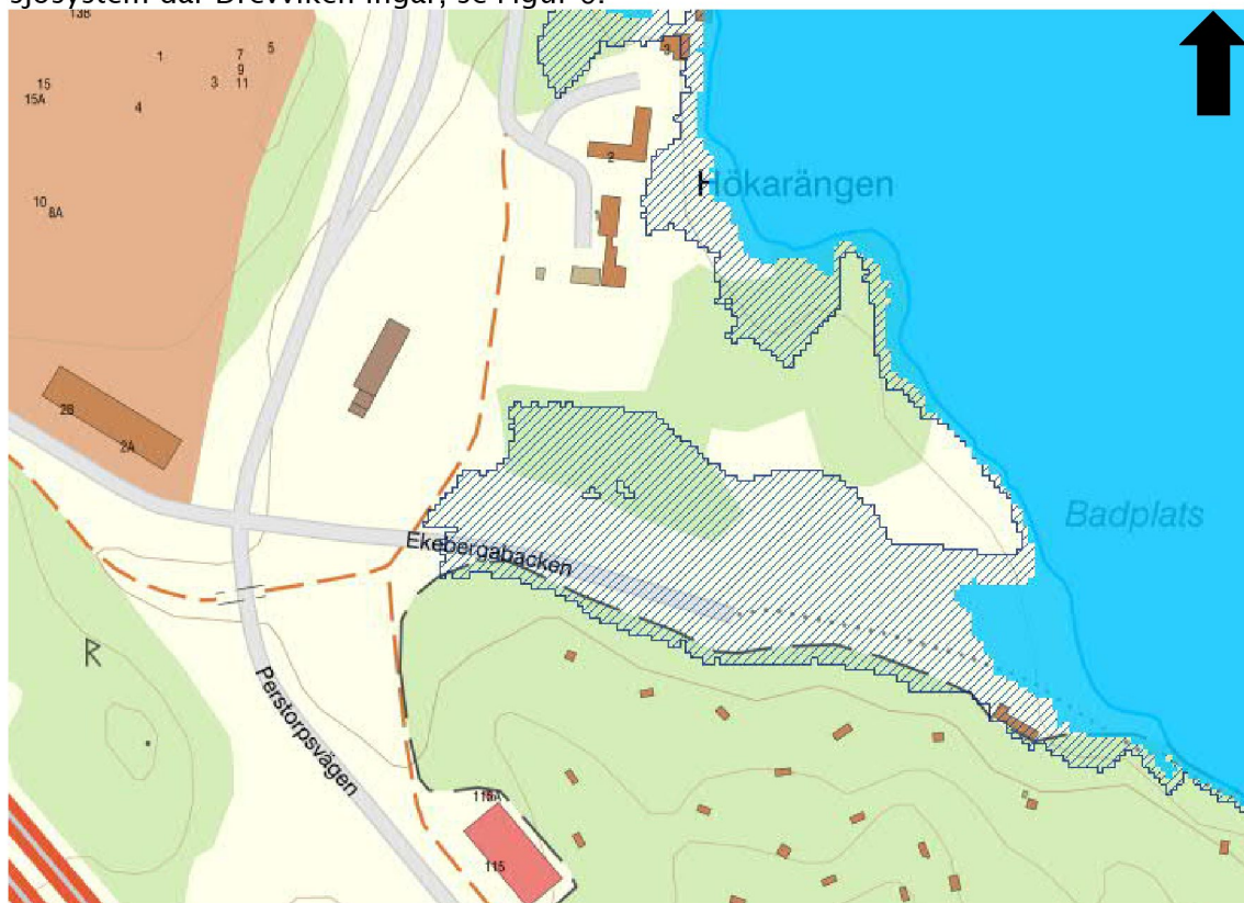
Figur 6. Översvämningsutbredning vid beräknat högsta flöde i Tyresåns sjösystem, där Drevviken ingår. Den ljusblå markeringen visar klimatanpassat 100-årsflöde och den blå skrafferade ytan visar det högsta beräknade flödet. Kvarter E nås inte av den beräknade utbredningen vid en översvämning. 12
