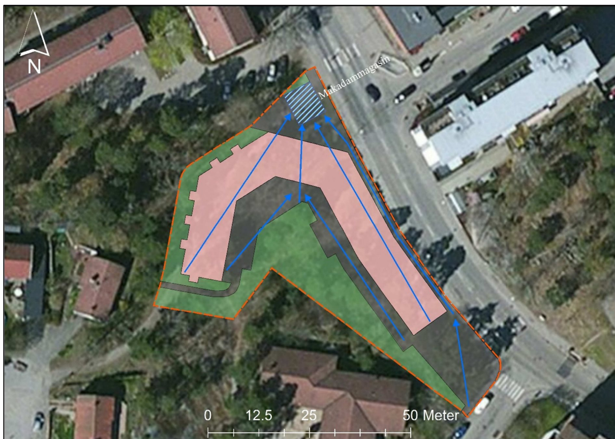
Figur 5-1. Principskiss med ungefärliga placeringar av föreslagen dagvattenhantering. Streckad yta visar ungefärlig placering av föreslaget makadammagasin dit dagvatten från planområdets hårdgjorda ytor leds.
