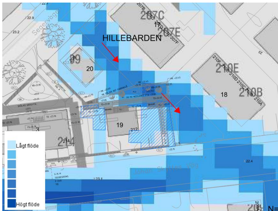
Figur 13. Skyfallsanalys Stockholm Stad (baserad på ett 100-årsregn , klimatfaktor 1,25 och varaktighet 6 timmar) samt markering av bedömd bortbyggd lågpunkt.
