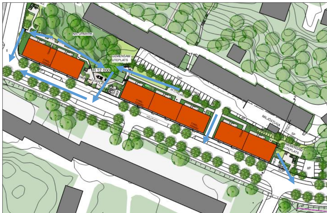
Figur 13. Vattnets rinnvägar efter exploatering (blå pilar markerar vattnets rinnriktning)
